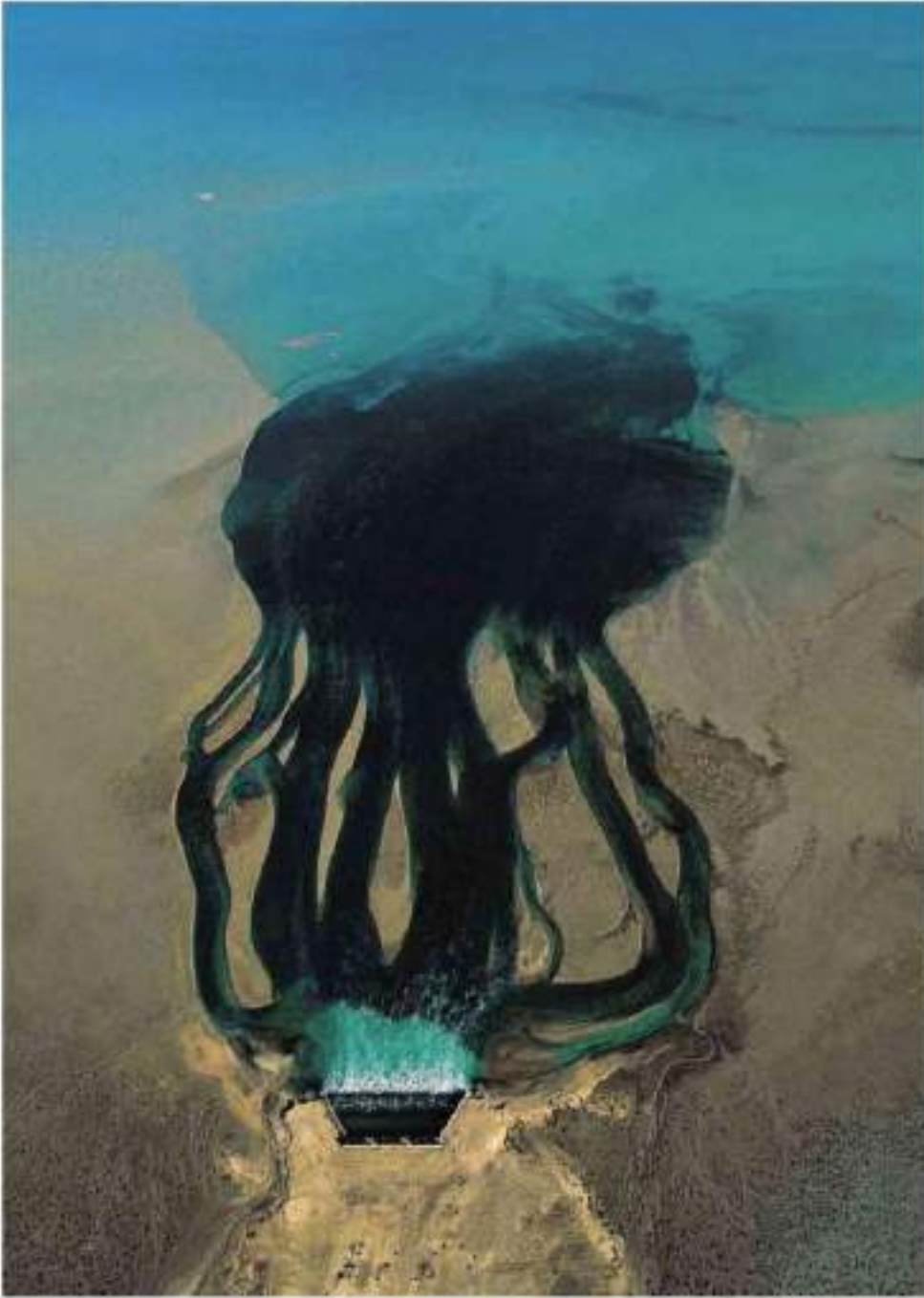
Rejets de l'usine de dessalement d'eau de mer d'Al-Duba (sur Adrienne) en Émirats.
